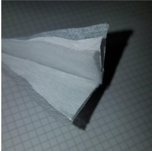
Abbildung 2: Eine Nahaufnahme einer aufgeschnitten FFP-2-Atemschutzmaske.
